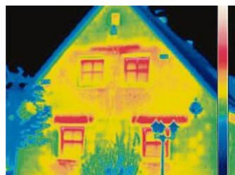
cken ins Auge – Stellen an der Hausfassade, an denen viel Wärme verloren geht. Der Thermograph erklärt deren Zustandekommen und gibt Tipps zur energetischen Sanierung des Hauses. Die Tipps sind auch für ähnlich gebaute Häuser gültig. Deshalb werden die begutachteten Häuser aus den eingegangenen An-
