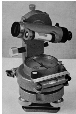
Ertel-Bautheodolit mit Glas- kreisen und abnehmbarer Kartier-Busssole, 1953.
