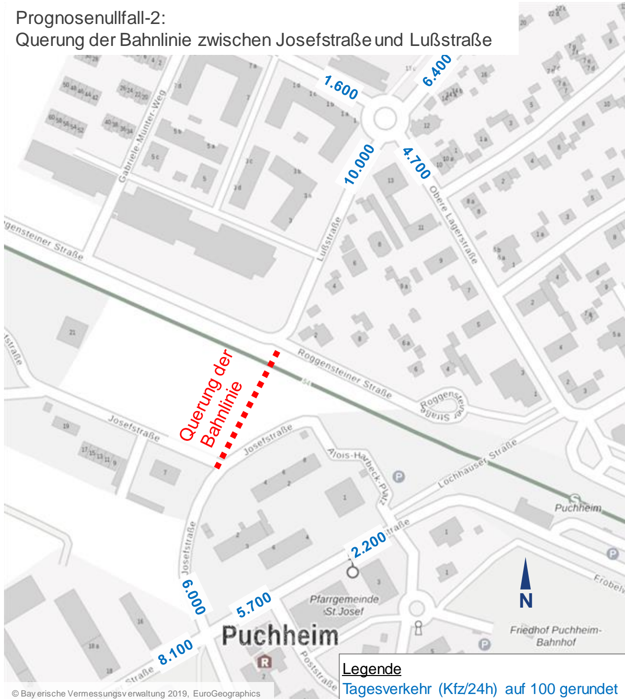
Abbildung 6: DTV w im Prognosenullfall-2 – Querung der Bahnlinie [Kfz/24h]
